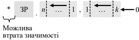
Рис. Б1-2.11. Операційна схема арифметичного зсуву ліворуч від’ємних чисел у ДК
