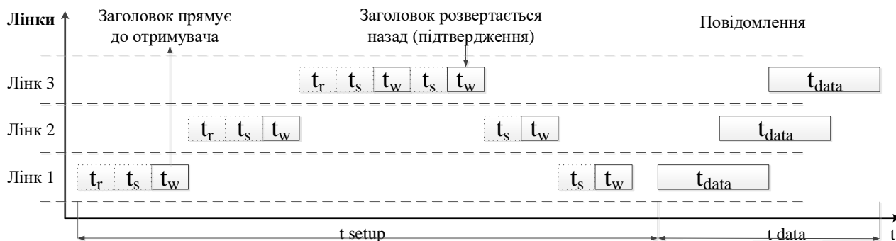
Рис. 3.12. Просторова-часова діаграма передачі даних на основі конвеєрної комутації каналів
