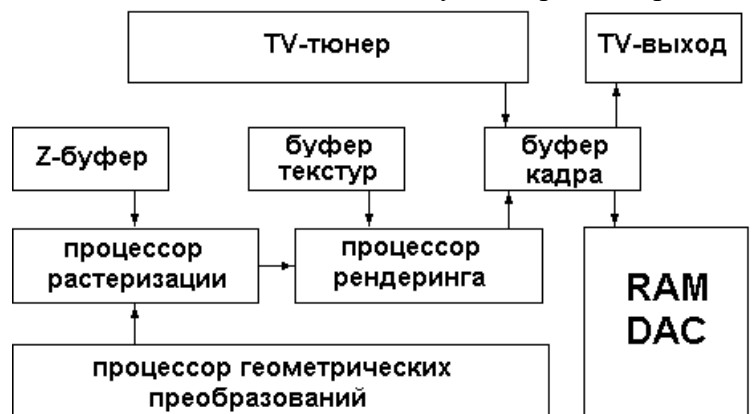
Рис. Структура відеоадаптера
