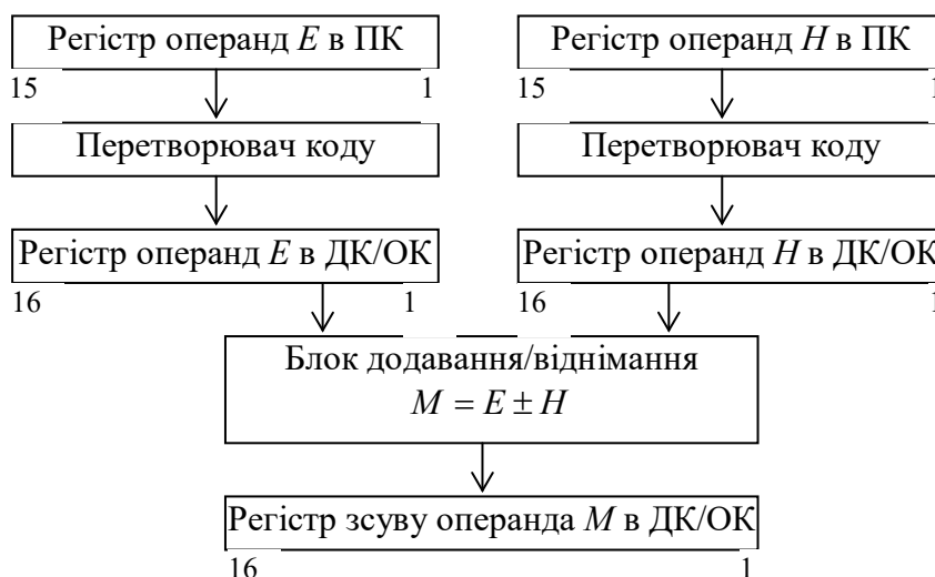
Рис. 1.14. Операційна схема пристрою
