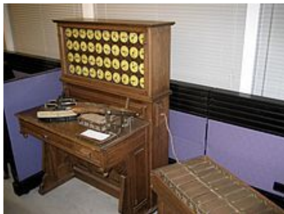
Табуююча машина Холлеріта з коробкою для сортування (1890)
