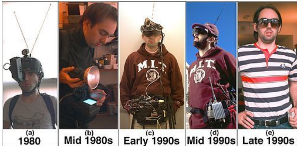
Еволюція переносного комп'ютера WearComp Стіва Манна від рюкзака до нинішньої прихованої системи
