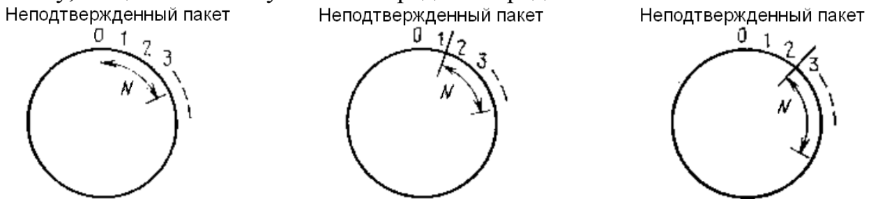
Рис 2.8.2.1. Управління за допомогою ковзного вікна: (а) - початковий стан, (б) - пакет підтверджений, (в) - наступний пакет підтверджений
