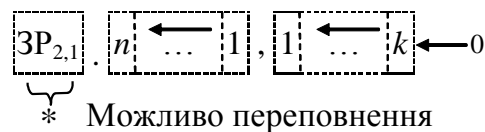
Рис. 1.7. Операційна схема арифметичного зсуву ліворуч від'ємних чисел у ДК
