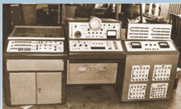
Система 2-ого покоління для керування електронно-променевою установкою з гострофокусованим пучком діаметром 0,1-5 мікрон
